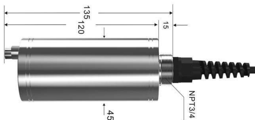
Рисунок 2 – Размеры датчика мутности ICB500-07
